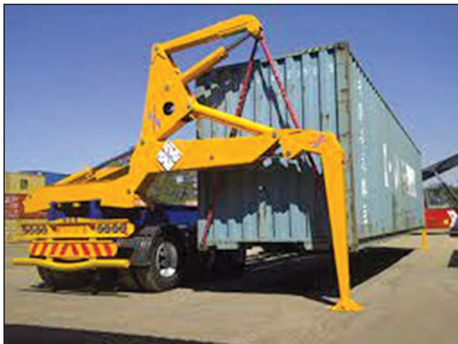
FIGUUR 13: Agteransig van 'n kanthyser wat 'n houer hanteer Bron: https://www.palfinger.co.za
