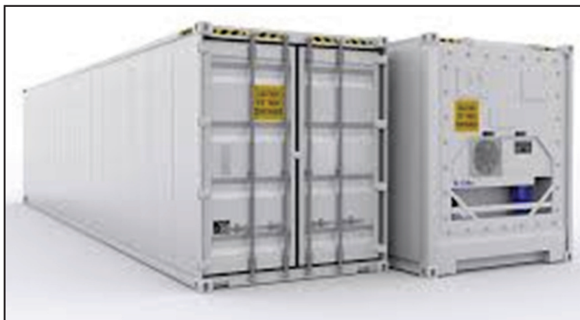
FIGUUR 11: Koelhouer, endwand met deure links en endwand met verkoelingsseenheid regs Bron: https://www.searates.com/reference/equipment/
