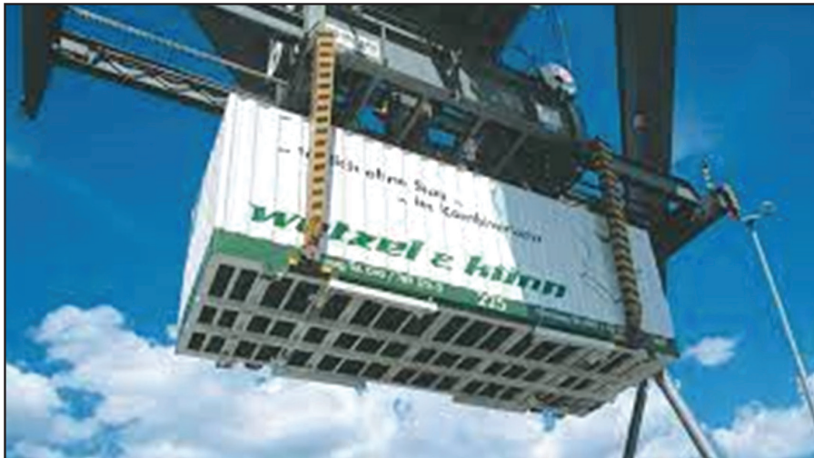
FIGUUR 17: 'n Gryphiser wat 'n houer aan die onderkant vasgryp tydens hantering Bron: http://www.intermodal-cosmos.eu
