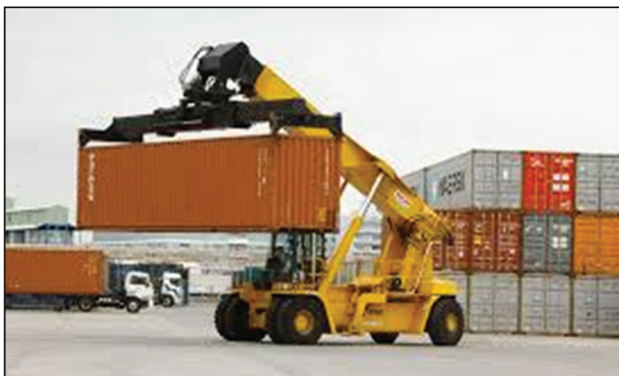
FIGUUR 15: Reikstapelaar wat 'n houer hanteer Bron: http://www.product.sanyglobal.com/
