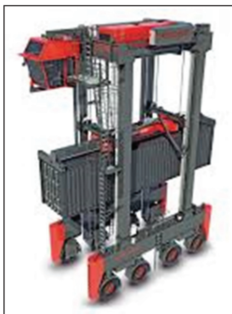
FIGUUR 16: Buidelwa wat oor 'n houer hurk en dit optel Bron: https://www.kalmarglobal.com
