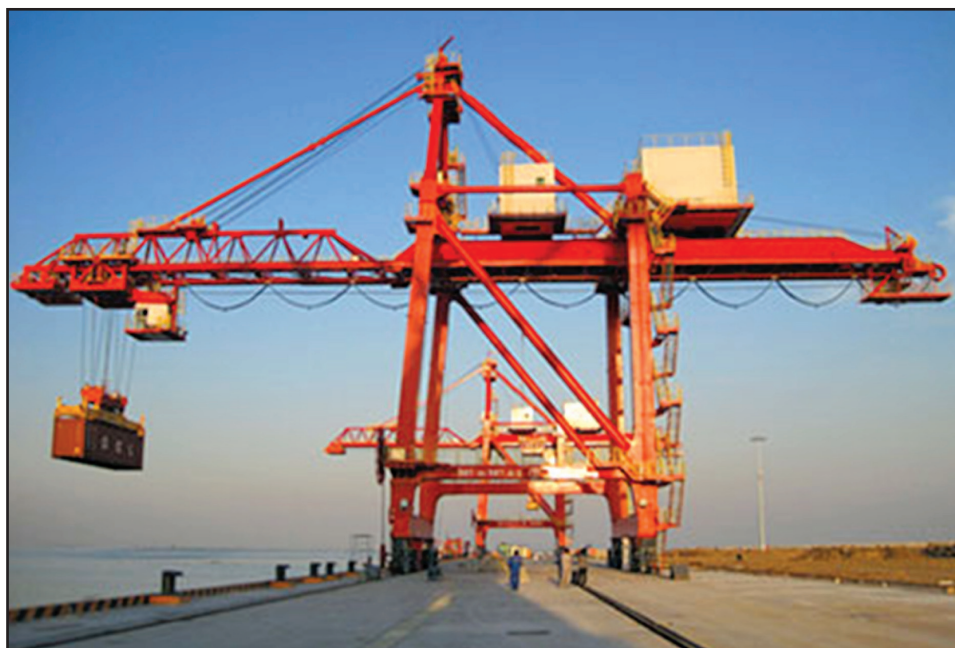
FIGUUR 19: 'n Skip-kaai-bokkraan wat 'n houer tussen 'n kaai en 'n sporeindpunt hanteer Bron: http://www.kellscrane.com
