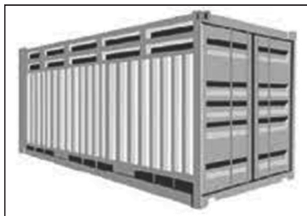
FIGUUR 8: Geventileerde houer Bron: https://www.searates.com/reference/equipment/
