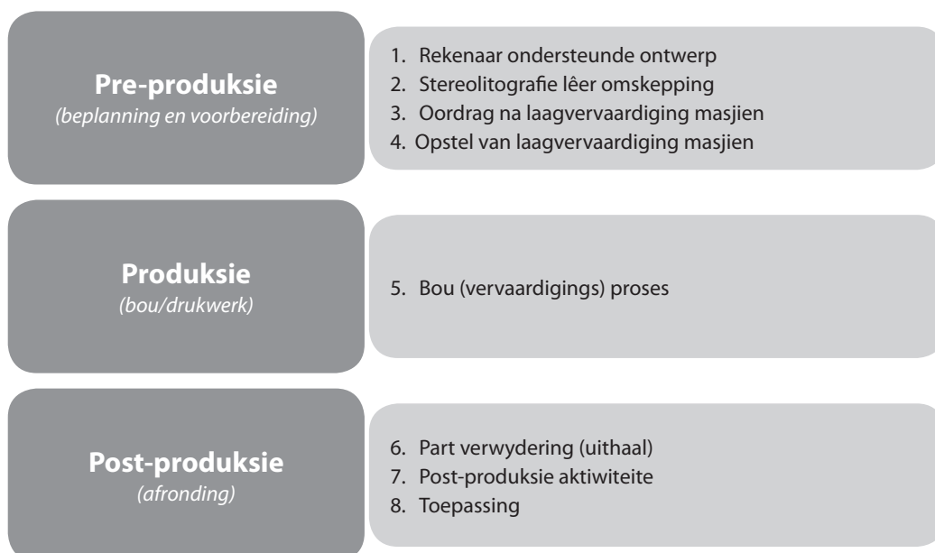
Figuur 1: 'n Skematiese voorstelling van die agt generiese laagvervaardigingstappe (Gibson, et al., 2015; Junk & Tränkle, 2011).
